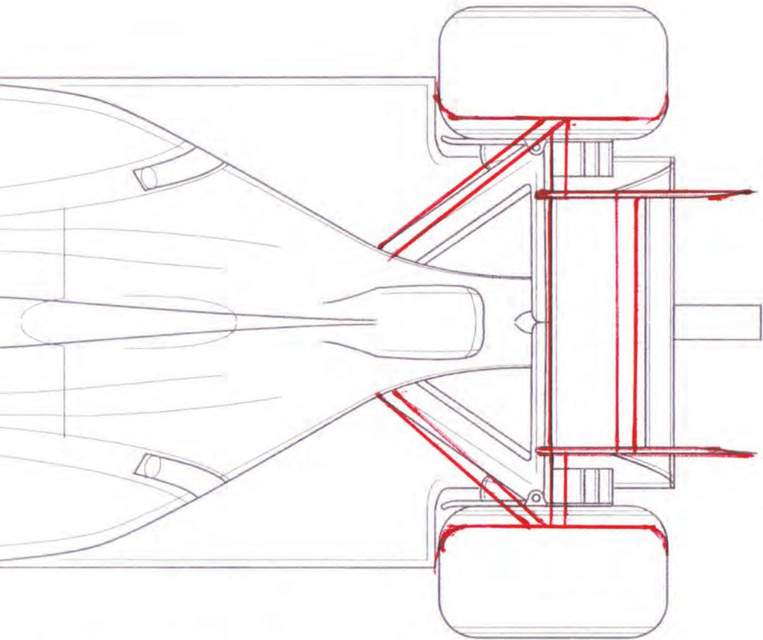
PLANK REMAINS - MORE VENTURI/DIFUSER FREEDOM (HEIGHT ABOVE PLANK) + FIXED SIDE HEIGHT (ABOVE PLANK) MORE DOWNFORCE IN CENTRE OF CAR - EASIER OVERTAKING
